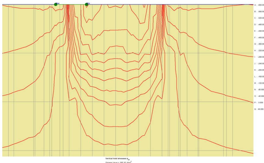
Рис. 5. Распределение вертикальных напряжений \sigma_v под фундаментной плитой 2×3,9 м вдоль ее продольной оси
